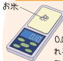
0.01gから重さを量れる携帯用計測器。仕組みはロードセル式、電磁式などがある。
