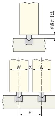
戸車・レールの組合せと床部すきま寸法(単位:mm)
