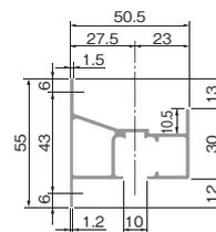
[材 質] アルミ押し出し材
