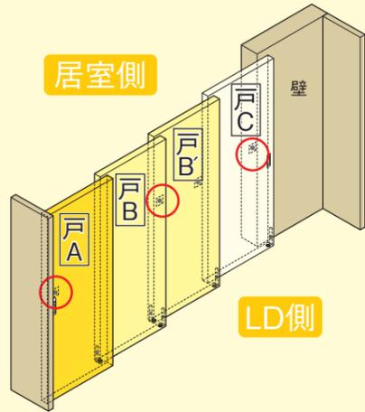
3 戸B、戸B'両端(2ヶ所)にある固定金具の操作ツマミを受金具の真上で下げ切って、受金具の中にシャフトをしっかりと差込み固定します。
