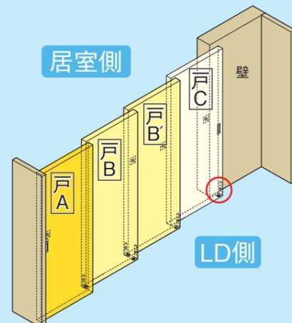
3 戸B、戸B'両端(2ヶ所)の固定金具の操作ツマミを上げ切って、シャフトを引き抜き、戸の固定を解除します。
