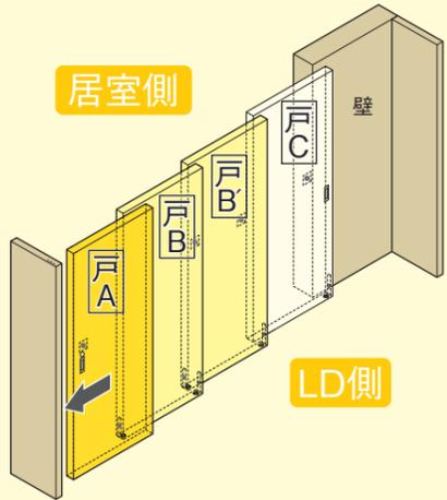
2 戸A、戸B'、戸Cの居室側にあるストッパー(3ヶ所)の上部を押込み、戸当たり部を突出させます。
