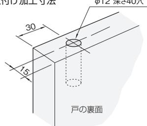
上部吊り車(HR-200)の取付け加工寸法
