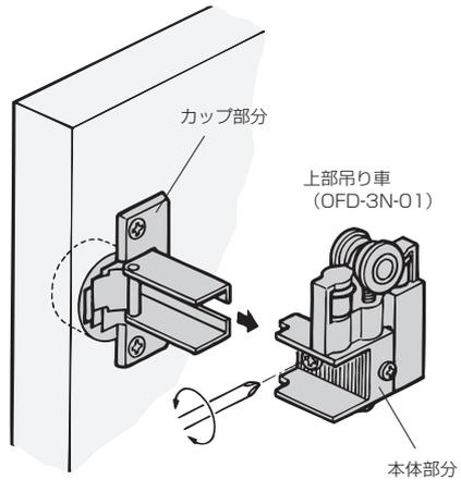
■戸の位置調整(調整代: 製品出荷時の状態より、前方向へ3mm、下方向へ7mm)
