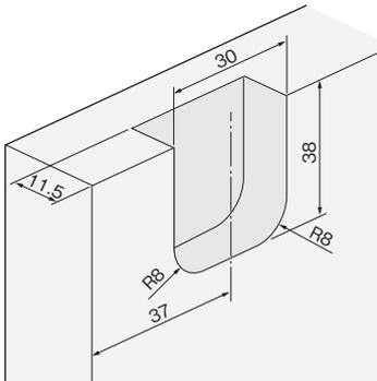
下部吊元固定金具(HR-450-SL)の取付け加工寸法
