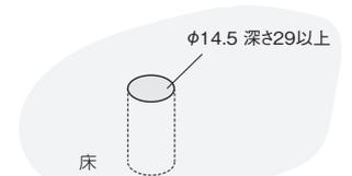
FG-N150-FBの取付け加工寸法
