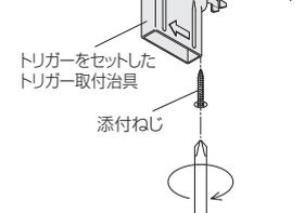
5. 簡易摩擦式キャッチの取付け
