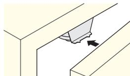
③治具を引き抜いて、ねじを締めます。
