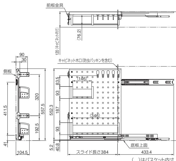
[材質] レール: 鋼 本体: 棚: アルミ フック: PA
