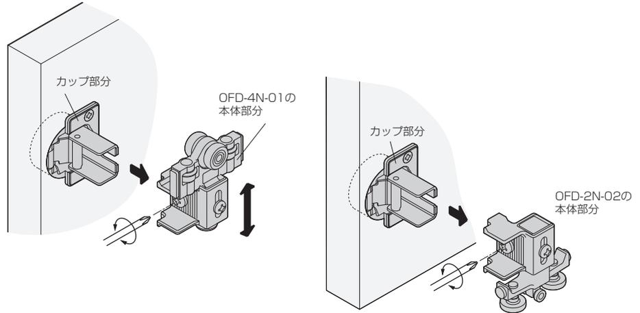
■戸の位置調整(調整代: 納品時の状態より、前方向へ3mm、下方向へ8mm)
