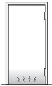
上下調整ねじを右に回すと、ドアが上がります。最大 2.5mm
