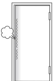
左右調整ねじを左に回すと、ドアが開き側に寄っていきます。最大 2.5mm
