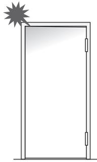
上下調整ねじを左に回すと、ドアが下がります。最大 2.5mm
