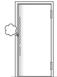
左右調整ねじを左に回すと、ドアが開き側に寄っていきます。最大 2.5mm
