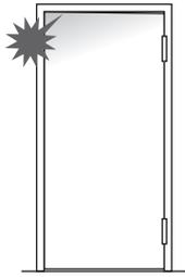
上下調整ねじを左に回すと、ドアが下がります。最大 5mm
