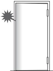
左右調整ねじを右に回すと、ドアが吊元側に寄っていきます。最大 2.5mm
