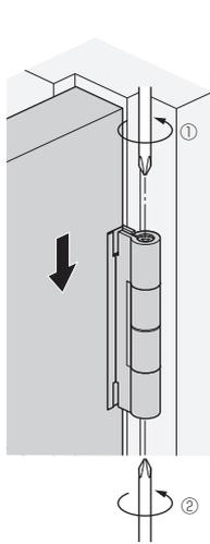
上下調整ねじを右に回すと、ドアが上がります。最大 5mm
