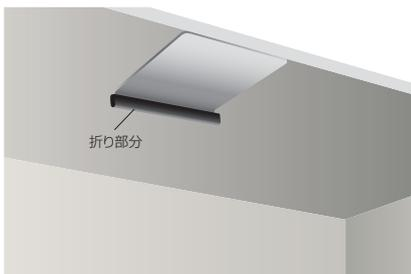
②取付用両面テープの裏紙をはがし、プレートの先端を投入口側の上部中央のフチに合わせて、プレートを天井に貼り付けてください(プレートの折り部分の向きにご注意ください)。
