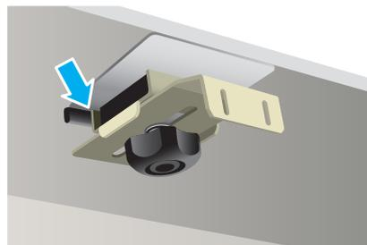
③チラシブロック本体をプレートの折り部分に押し当て、磁石で取付けてください。
