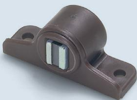
●マグネットケースをドライバーあるいはコインなどで回すと、マグネットケースが前後にスライドしますので、マグネットの位置調整が容易にできます。(調整代=3mm)
