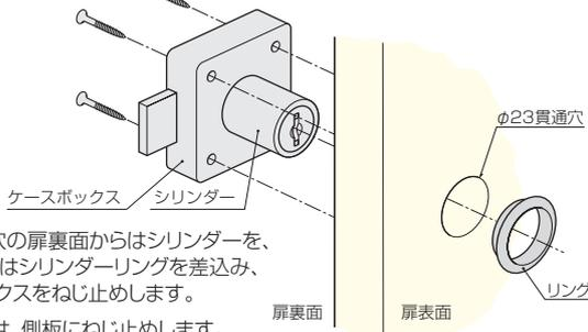
φ23貫通穴の扉裏面からはシリンダーを、扉表面からはシリンダーリングを差込み、ケースボックスをねじ止めします。
