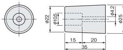
●片寄った荷重により、天板昇降金具のブラケットなどが変形する事を防止します。
