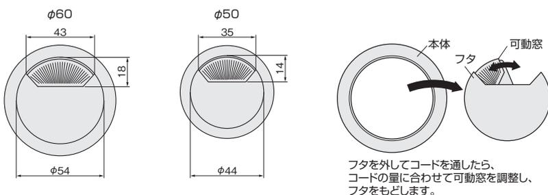
フタを外してコードを通したら、コードの量に合わせて可動窓を調整し、フタをもどします。
