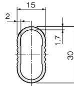
[材 質] アルミ押し出し材
