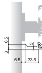
[材 質] アルミ押出し材
