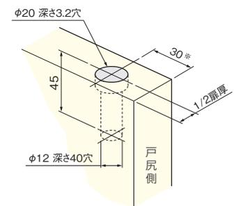
※使用する上部吊り車の吊り軸と同じ位置に取付けてください。
