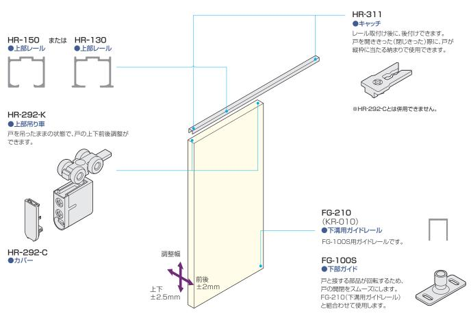
※前後調整付き吊り車を使用する場合は、吊り車·下部ガイドを前後調整付きに統一してで使用ください。
