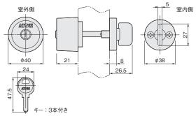
[材 質]エスカッション、サムターン:亜鉛合金 シリンダー: 亜鉛合金 キー:真鍮
