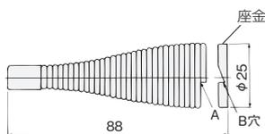
座金をねじ止めた後に、AをB穴に挿入してねじり込み取付けます。
