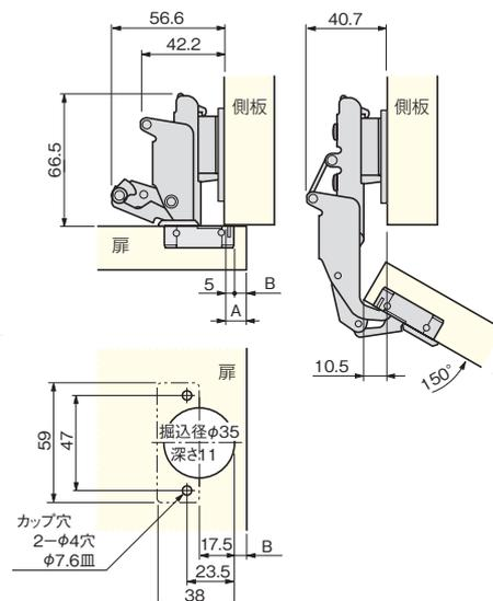
A=扉のかぶせ代 B=扉端より掘込みまでの距離
