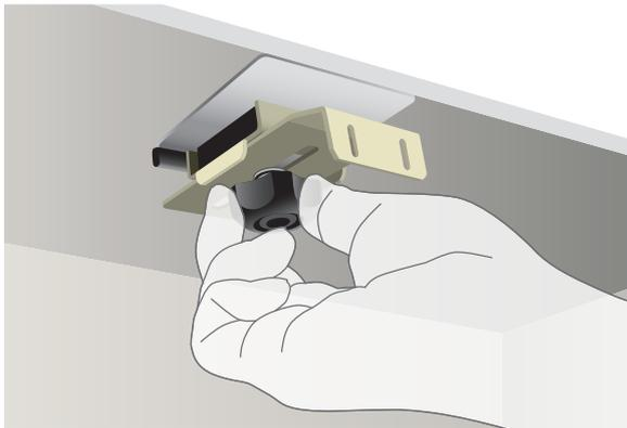
⑤可動式アングルをスライドさせ、閉じたフラップに先端が当たる位置でツマミを締めて固定してください。
