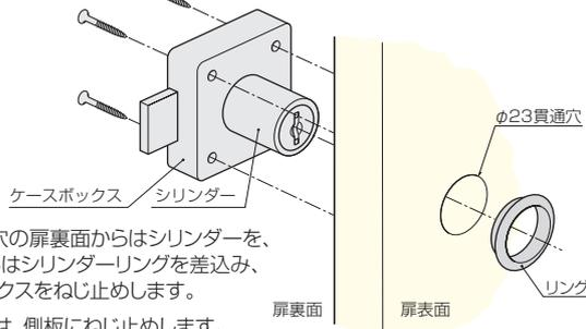
φ23貫通穴の扉裏面からはシリンダーを、扉表面からはシリンダーリングを差込み、ケースボックスをねじ止めします。
