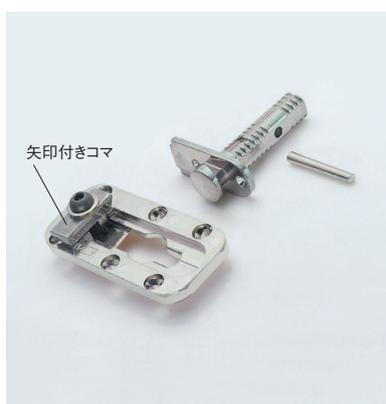
**A5** 脚の断面が多角形の場合、取付け穴の加工位置は、角部と平面部のどちらでも32mmの寸法を守っていただければ取付けは可能です。ただし平面部を基準にしますと、矢印付きコマでテーブル脚用金具を固定する際に、矢印付きコマの角が脚の平面部を傷つけてしまう可能性がありますのでご注意ください。
