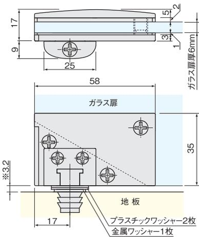
本図はガラス扉厚6mm、フロントプレート側パッキン2mm、バックプレート側パッキン1mmを使用の場合
