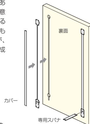
**Q7** 扉反り矯正金具の調整可能寸法は何mmですか？ また、その最大調整寸法まで、ナットは何回転させなければなりませんか？
