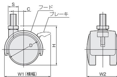
[材 質] 車、カバー、ブレーキスイッチ: PA 取付部: 鋼
