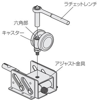
②連結ワイヤーにアジャスト金具を接続します(4ヶ所 下図参照)。次に、センター軌道金具とアジャスト金具を台輪の所定位置にねじ止めします。
