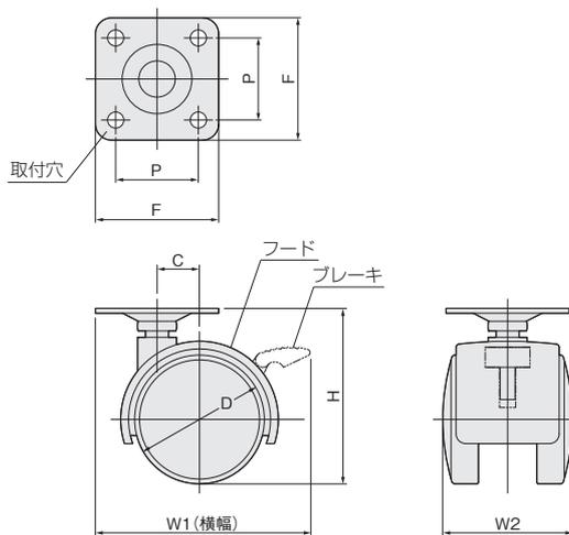
[材 質] 車、カバー、ブレーキスイッチ: PA 取付部: 鋼
