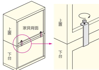
マイナスドライバーでねじの先端部が裏側にくい込むようにして金具を固定してください。
