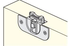
戸の上部裏面に掘込んで取付けます。AS上部レールの中を走行します。戸の上下調整をおこなってもキャッチ力が一定です。上部ストッパーには、AS上部ストッパーを使用します。
