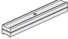
戸の開き角度50°で仮ストップする機構を持たない丁番(HD-38など)を使用して戸の開閉方法をフリーオープンタイプにしたい場合に必要になります。ねじは締め付けしないで、レール内を左右に自由に滑走するようにしておきます。
