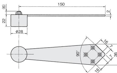
取付け位置を左右にずらすことによって、ドアの開き角度が自由に選べます。
