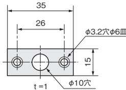
[材 質] 本体・受金：亜鉛合金、平受金：鋼（ユニクロ）
