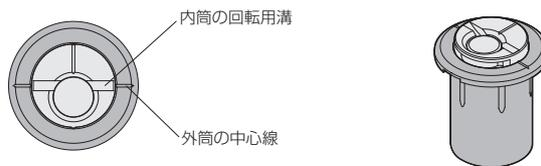
②内筒側面のくぼみに工具などを差込み、内筒を外筒から引き出します。
