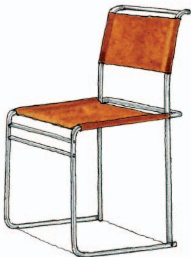
デザイン：マルセル・ブロイヤー 鉄パイプチェアに初めて背がついた作品。 カンチレバーの鉄パイプチェアのヒントになったチェア。
