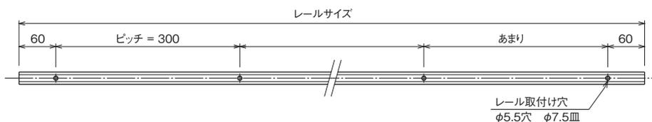
※レール固定ねじとスライダーの干渉防止のため、1.5mmの隙間を設けてあります。
